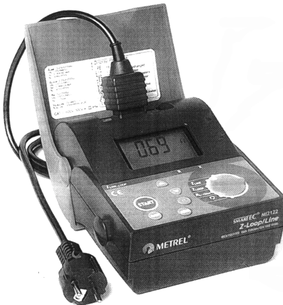
Slika 1. Mjerilo otpora zamke tip SMARTEC Z Loop/Line MI 2122
